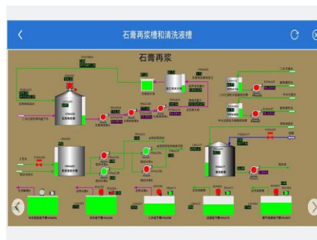
输浆管压力表监控
